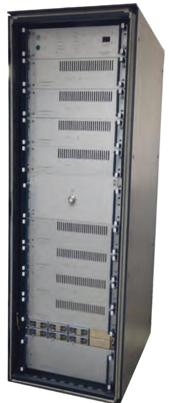
**Familie AM96: Holographischer Radar-Transmitter-Verstärker zum Schrankeinbau**
