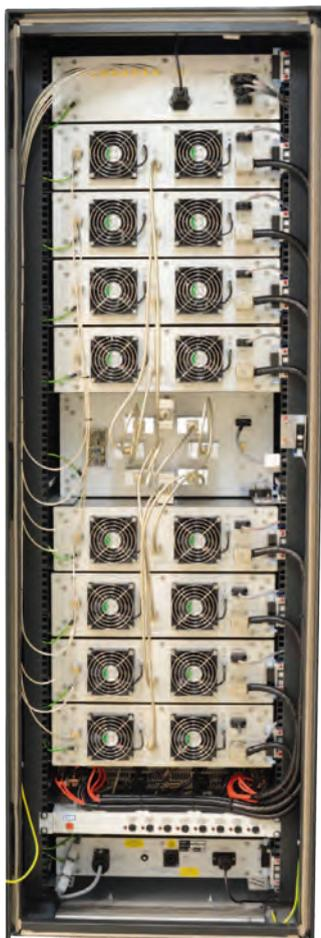
**Familie AM96: Holographischer Radar-Transmitter-Verstärker (rückseitige Ansicht)**
