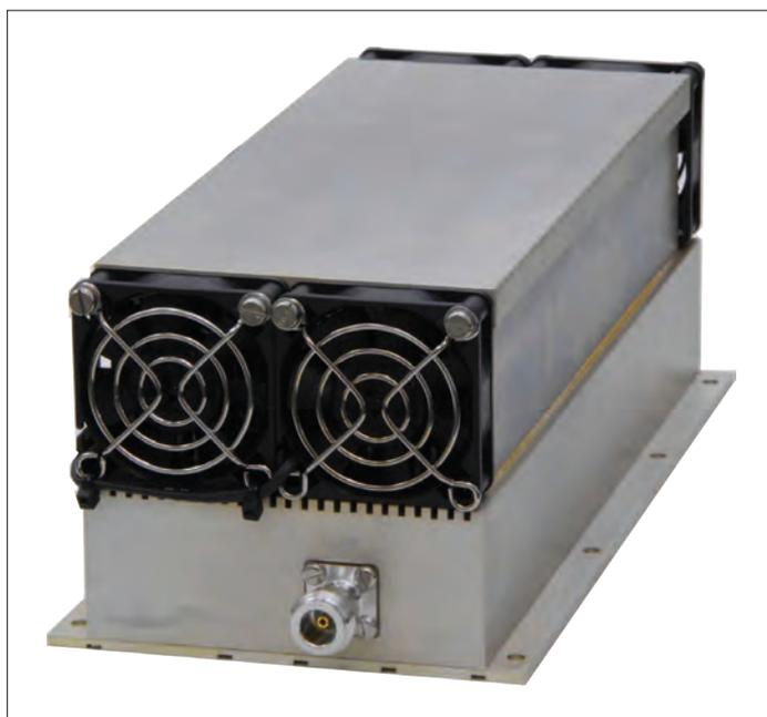
**Familie AM81: IMD-Testsystemverstärker für mobile Kommunikation**
